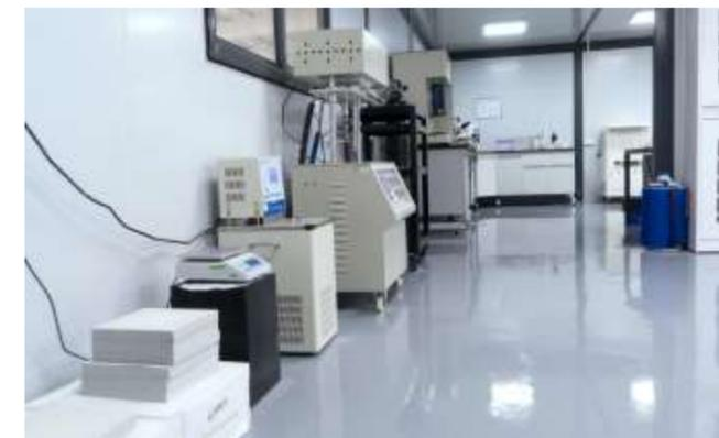
成品检验检测实验室主要仪器设备：高精度常温导热系数测试仪、高精度高温导热系数测试仪、永久线高温收缩率测试炉、材料万能试验机。
